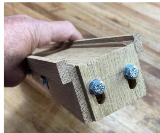
Voorkant waarteen die werkstuk vasskop, se hoogte is ook verstelbaar
