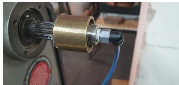
Verbinding tussen vakuümpomp en draaibank
