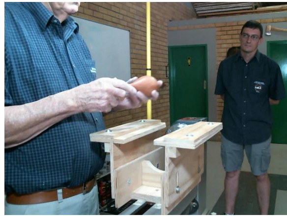
Willie verduidelik hoe die diepteskaaf die profiel op die bed volg.
