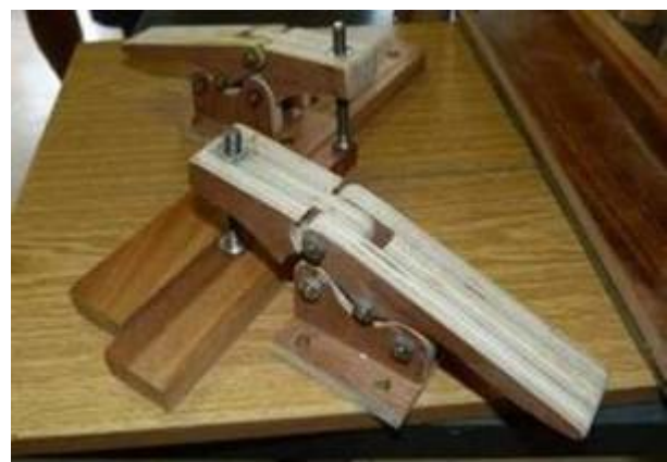
Van die hulpmiddels wat David gemaak het, én gebruik, om unieke patrone op draaiwerk te kan aanbring.
