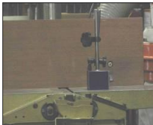
Foto 4: Apparaat om skaaflemme se hoogte mee te stel
